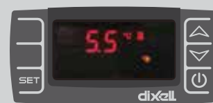
Kontroler XR60CX mikroprocesor sadrži integrisani ekran sa ikonama.
